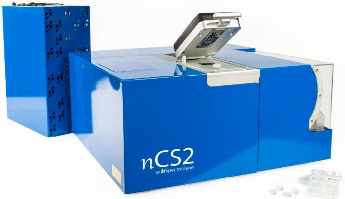
より鮮明で正確なナノ粒子径分布・濃度測定
